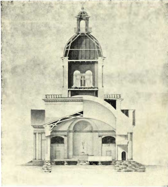
Fig. 4. Tvärgenomskäring genom långhuset och tornet, daterad 25 februari 1828. Korets och altaruppsatsens utformning påminner som synes mycket om motsvarande i den nuvarande kyrkan.
