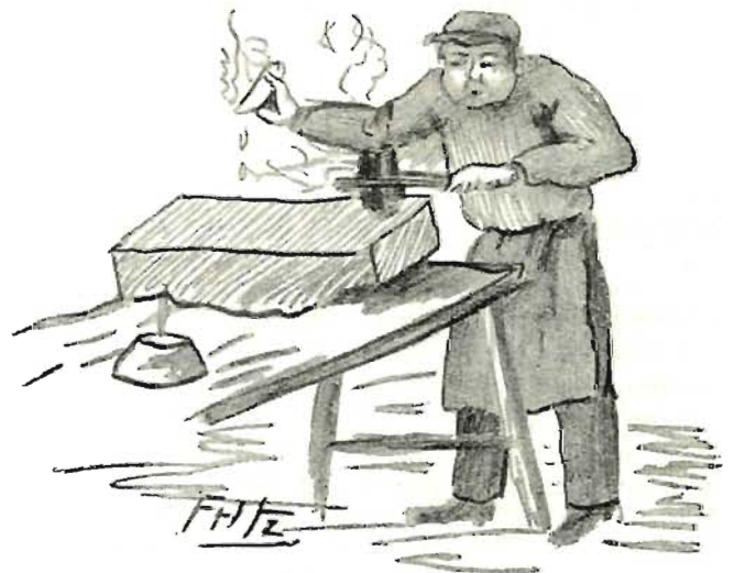
Lagning av sten med träkol och naturbälg.
