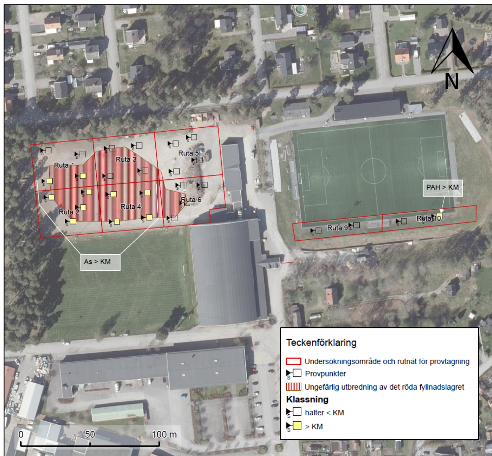
Figur 4. Sammanställning av högst uppmätta halt i respektive provpunkt från undersökningen 2022. Ungefärlig utbredning av fyllnadslager med rödfyr inom röd/vit streckat område.
