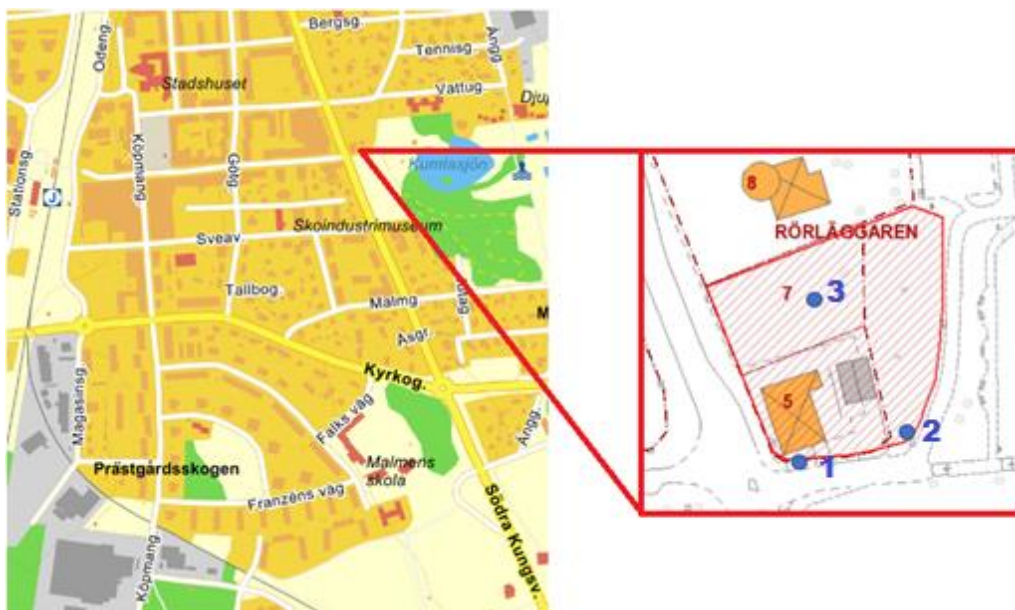
Figur 1. Karta över Kumla (eniro.se) samt delförstoring av fastigheterna Kv. Rörläggaren 5 och 7 samt angränsande parkområde med provpunkter för porluftmätning markerade i blått och numrerade 1-3.
