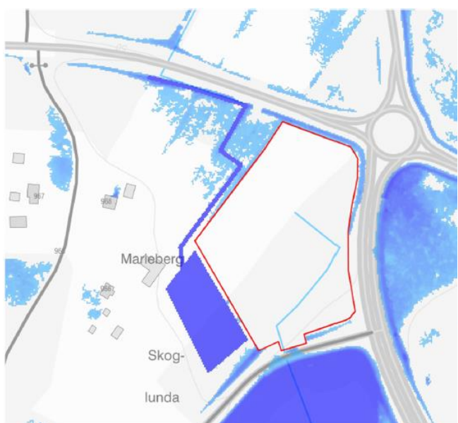
Figur 14. Stående vatten vid skyfall med planerad damm, Scalgo
